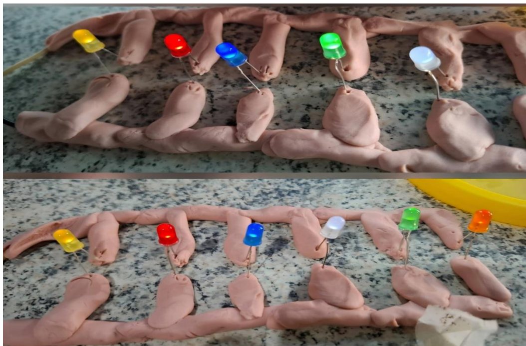
Imagem 5: Representação do circuito em paralelo com utilização de massinha
