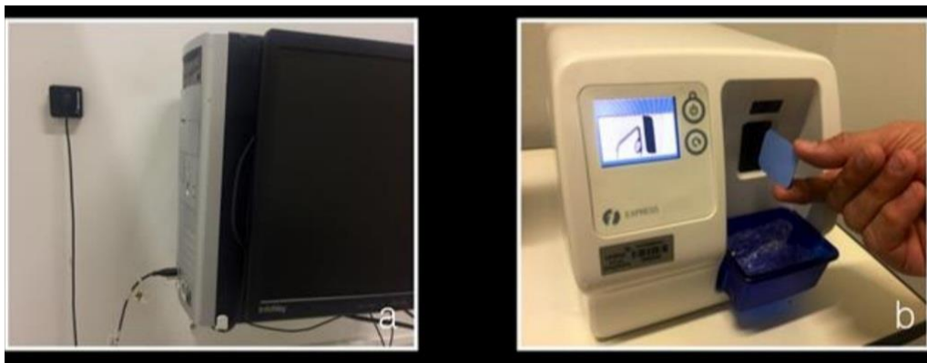
Figura 4: Sensor sólido acoplado a saída USB do computador (a); Posicionamento da placa de fósforo fotoestimulável no escaner para leitura (b). Fonte: IKUTA, SALZEDAS; 2018.
